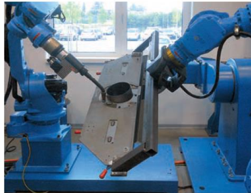
MaG-Schweißen an diversen Gehäuseteilen und Unterbaugruppen ES165 mit MA1800 Sensorik: taktiler Sensor und Lichtbogensensor
