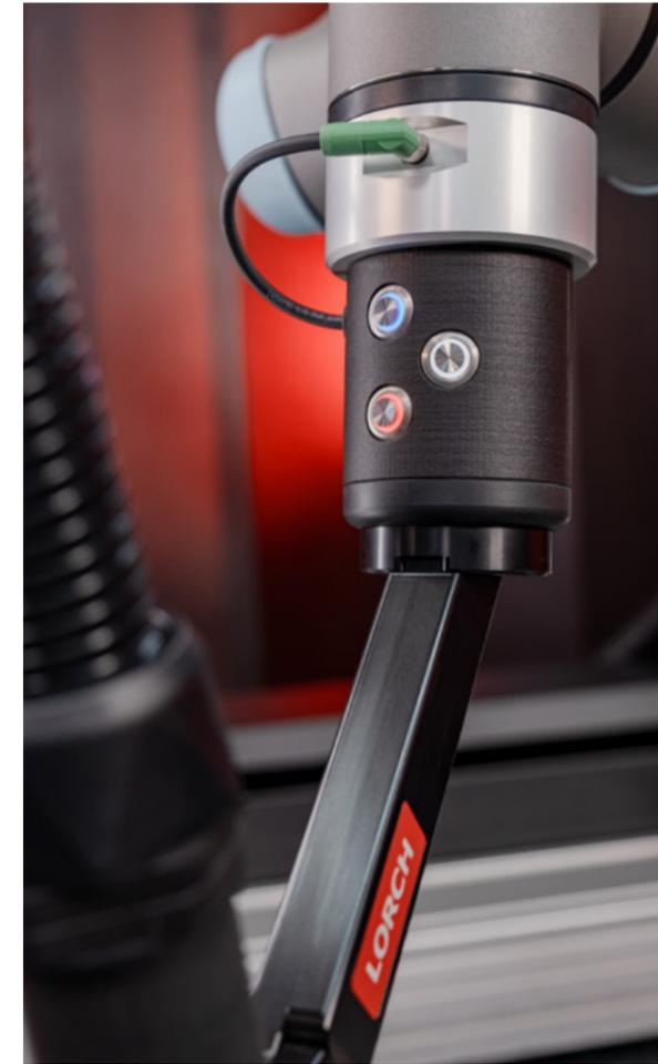
Mit dem Multifunktionsflansch wird das Programmieren vom Bedienfeld direkt an den Roboter gebracht. Das spart nicht nur Zeit, es ist auch für die Vorgabe der Schweißaufgaben bedeutend einfacher. So können Sie innerhalb von Minuten neue Bauteile programmieren und einlernen.
