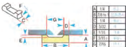
Trapezform mit kleinerer Teilung vom 6,3 mm Länge empfiehlt sich zum Einsatz in Rohren und Behältern mit kleinem Durchmesser trapezium shape, each in 1/4" length making it much more flexible to wrap around smaller diameters of pipe and vessel.
